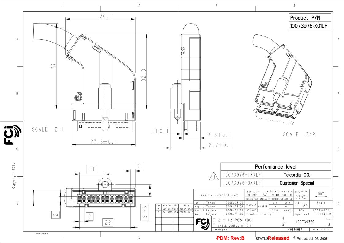
KIT: 10073976-X01LF QTY REP COMPONENTS BOTTOM COVER TOP COVER + SCREW 3 CABLE CLAMP CLAMP SCREW Δ TERMINAL BLOCK TERMINAL BLOCK CABLE
